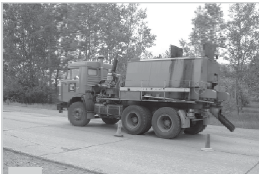
Автодор постоянно обновляет дорожную технику, одна из приобретенных машин: термос-миксер ОРД-1025.1 для транспортировки и укладки литых асфальтобетонных смесей при ремонте дорожного покрытия
