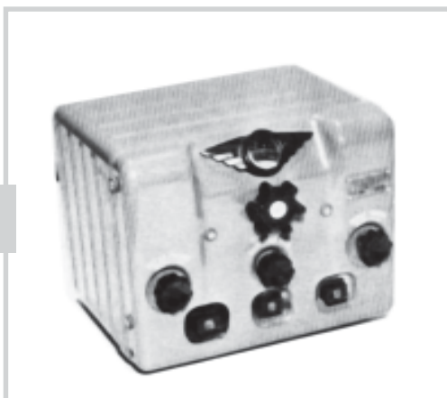
Радиоприемник УС-3С связной самолетный выпускался в годы Великой Отечественной войны
