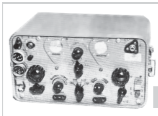
Радиостанция РБМ приемо-передающая переносная выпускалась в годы Великой Отечественной войны
