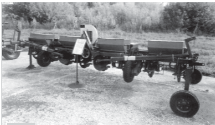
Сеялка пропашных культур СПК-8 «СибДон»
